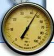
6.7. Гигрометр — прибор для определения относительной влажности воздуха
